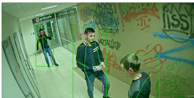
Рис. 2а. Метаданные от нейронных сетей и других математических анализаторов (рамки объектов, ключевые точки, классы и идентификаторы)
